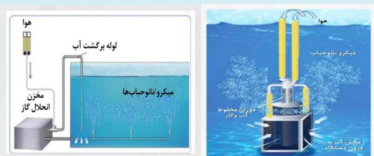
شکل ۷. روش رفع فشار جهت تولید میکرو/نانوحباب
