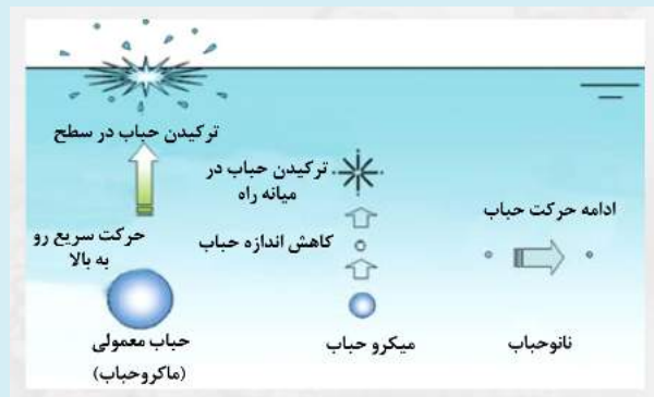
شکل ۱. رفتار متفاوت ماکرو حباب (بالای ۵۰ میکرومتر)، میکرو حباب (بین ۱۰ تا ۵۰ میکرومتر) و نانوحباب (کمتر از ۲۰۰ نانومتر) در آب
